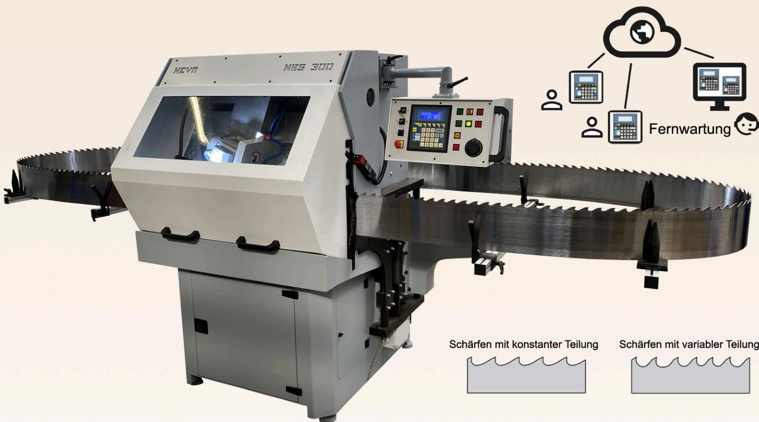
Die NBS 300 ist mit der Querachse ausgestattet und somit trapezförmige oder abwechselnd schrägen Zähne geschärft werden können. Ein weiterer Vorteil der Maschine ist der servogesteuerte Vorschubfinger, der einen schnelleren Zykluslauf gewährleistet, da er mit dem Vorschub beginnt, sobald sich die Schleifscheibe zurückbewegt.
