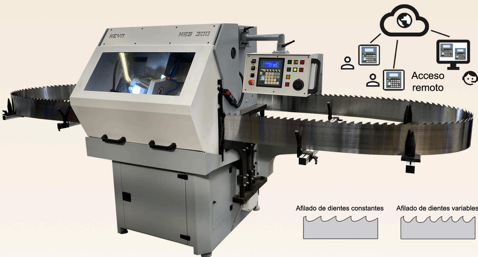
La afiladora CNC de sierras de cinta NBS 300 está equipada con el eje transversal, facilitando así el afilado de los dientes trapezoidales o los alternos oblicuos. La siguiente ventaja de la máquina, el dedo alimentador controlado por el servomotor, asegura un ciclo más rápido, como comienza a alimentar ya en el momento de movimiento de retroceso de la muela de afilar.
