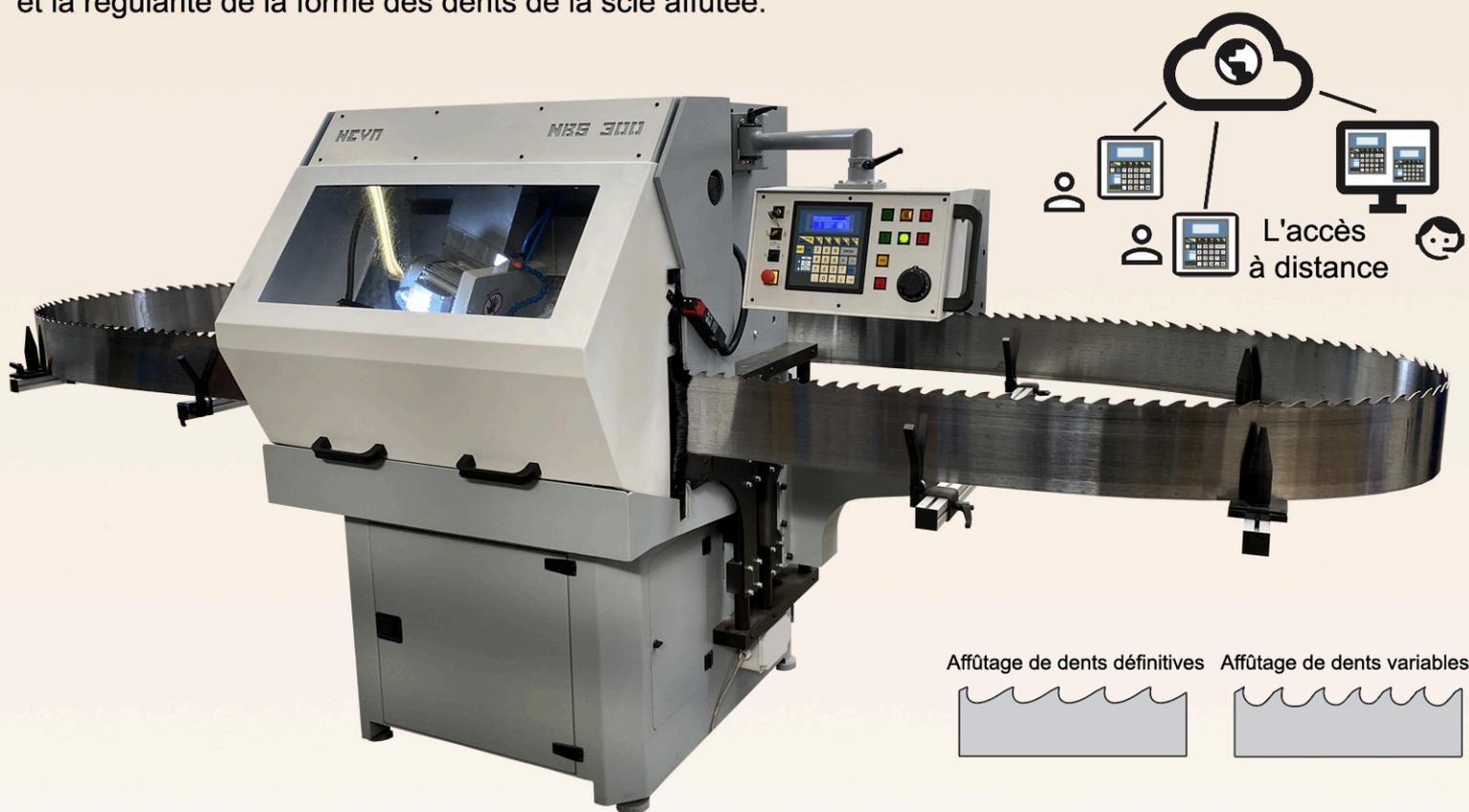
Contrairement à nos autres affûteuses, le ruban de scie est orienté verticalement lors du travail. Affûteuse de scie à ruban NBS 300 est équipée d'un axe transversal et peut affûter des dents trapézoïdales ou à contre-dépouille. Un autre avantage de la machine est le pouce d'alimentation commandé par un servomoteur, qui assure un temps de cycle plus rapide car il commence à alimenter dès que la meule recule.
